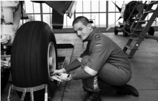
Bilduntertitel: *Hauptgefreiter Maertens prüft den Luftdruck eines Flugzeugreifens*. Quelle: <http://goo.gl/ptTxO> [24.02.2014].
